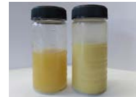
Abbildung 4: Mineralöl links, DOT mit erhöhtem Wasseranteil rechts
