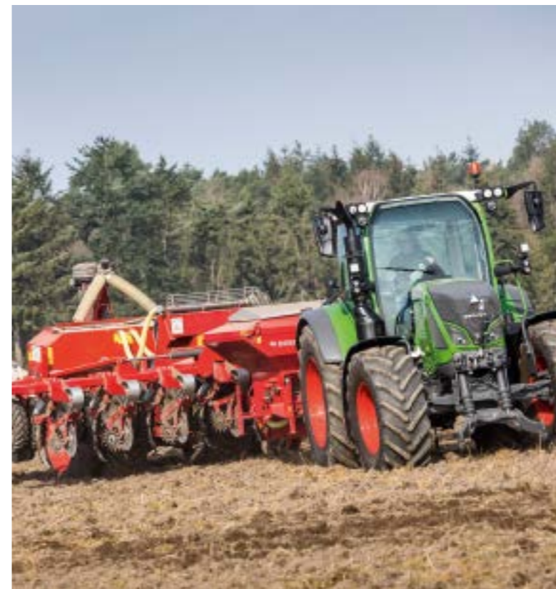
Die Strip-Till-Maislegemaschine wurde von Grund auf selbst gebaut. 10 m lang ist die Eigenentwicklung und 6 m Arbeitsbreite bringt die Maschine mit.
